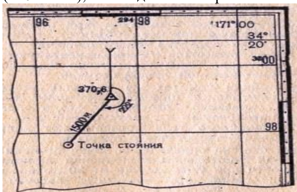
Рис. 5.12 Определение точки стояния по направлению и расстоянию
